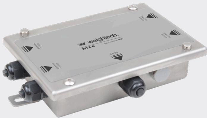
A nova Caixa de Junção WTX-4 foi desenvolvida para entregar robustez mecânica, consistência e simplicidade na instalação. É encapsulada em aço inoxidável NEMA4x/IP68, é perfeitamente vedada para aplicação sem ambientes externos, com prensa-cabos plásticos para uma resistência contra interferências elétricas e uma válvula equalizadora de pressão para proteção adicional contra condensação interna.
