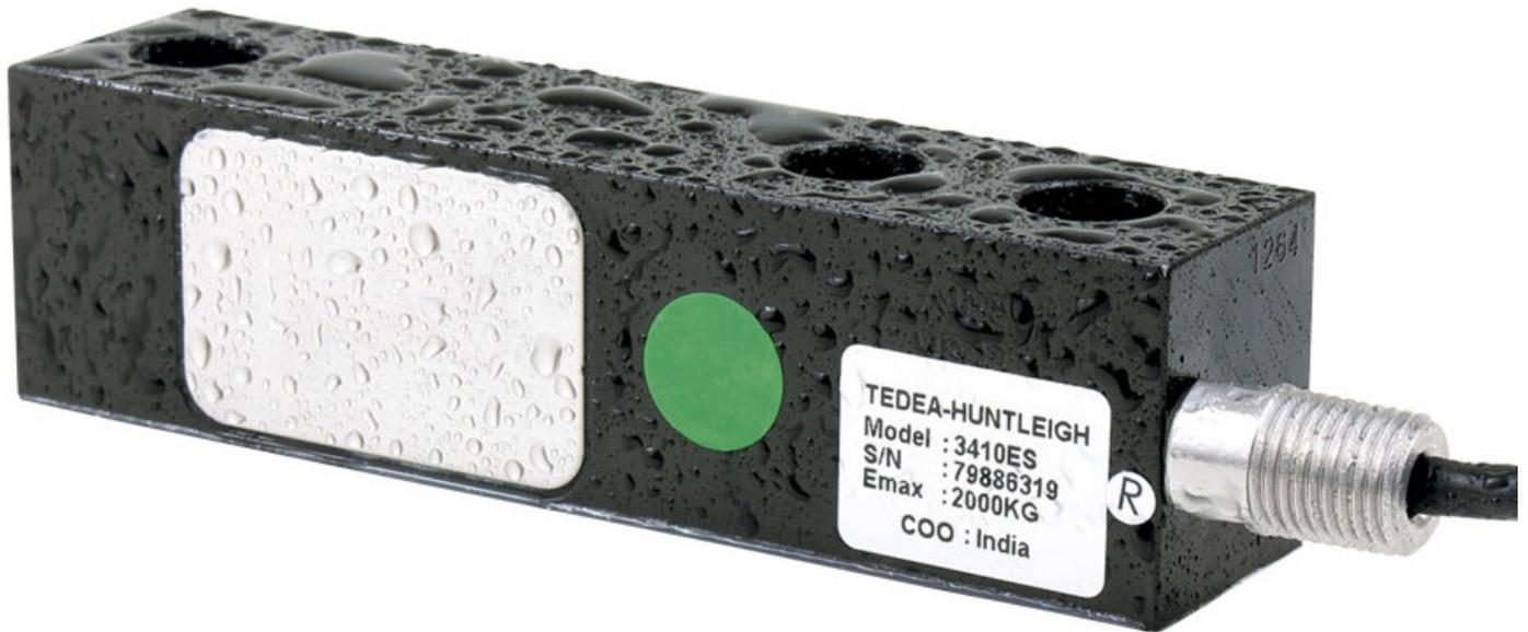
As Células de Carga Shear Beam 3410-ES e 3410-ESH são a obra de arte da Vishay. Com vocação para balanças tronco na aplicação pecuária, são perfeitas para instalação em pares sob as barras de pesagem. Além disso, a precisão insuperável da 3410-ES (equalizada em 0,002 mV/V) é tão alta, que dispensa calibração de canto da balança, mesmo que ela não empregue uma caixa de junção.
