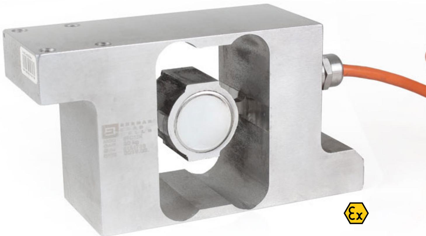
A BPC12X é uma célula de carga de ponto único, projetada para processos de pesagem dinâmicos, podendo ser utilizada para plataformas de até 600 x 600mm. Construída em aço inoxidável, conta com um grau de proteção IP68, garantindo uma vedação hermética completa. Possui aprovação ATEX para ambientes hostis.
